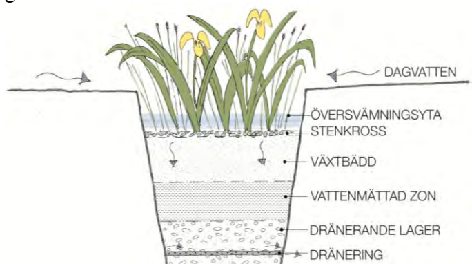
Figur 22. Exempel på uppbyggnad av en regngård
